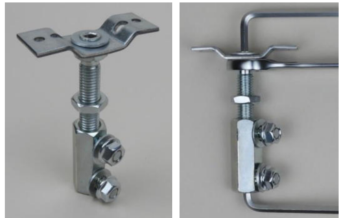
Abbildung 88: WU-Justierelement-M12x70-F, justierbar von oben, unten und von der Seite
