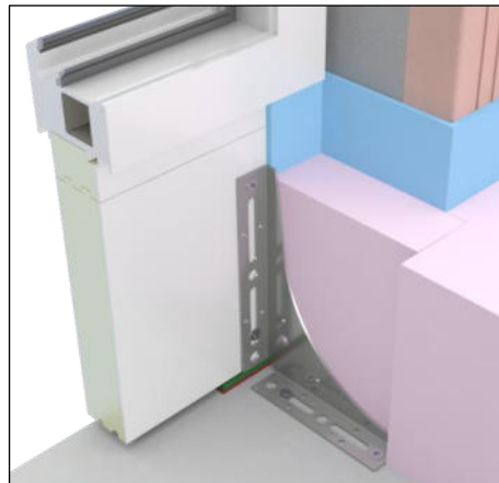
Abbildung 73: SLW - Befestigung unten am Anschlussprofil
