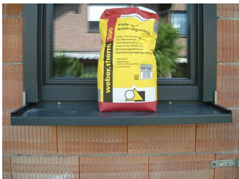
Abbildung 94: Baustelle: 30 kg Sack – Fensterbank hält!
